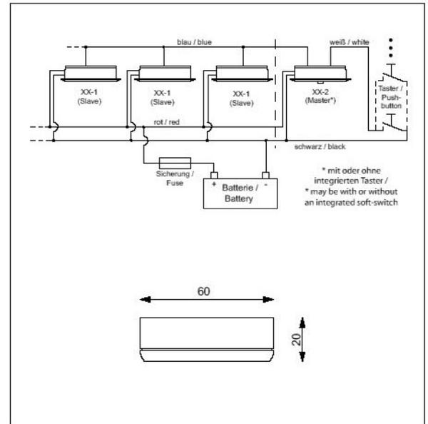
Betriebsspannung 12 V und 24 V Gleichspannung (10 - 30 V DC)
